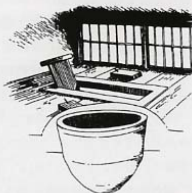
便所の便槽として使用した例
